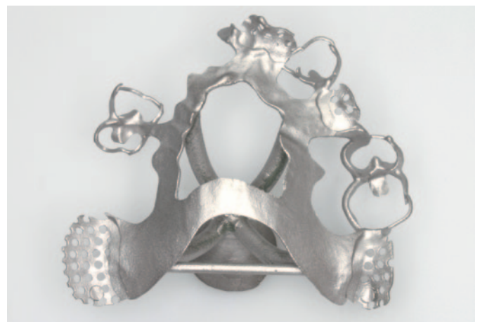
Abb. 18 Der Modellguss nach dem Gießen.
